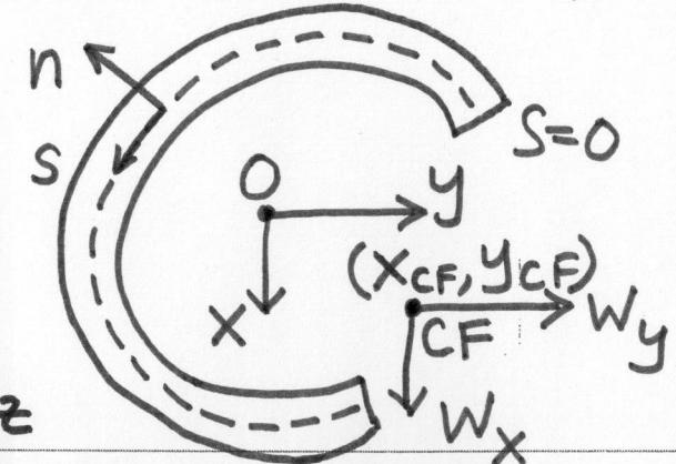
$$\tau_z = -\frac{(M_x I_{xy} + M_y I_x)}{\Delta} x + \frac{(M_x I_y + M_y I_{xy})}{\Delta} y$$
